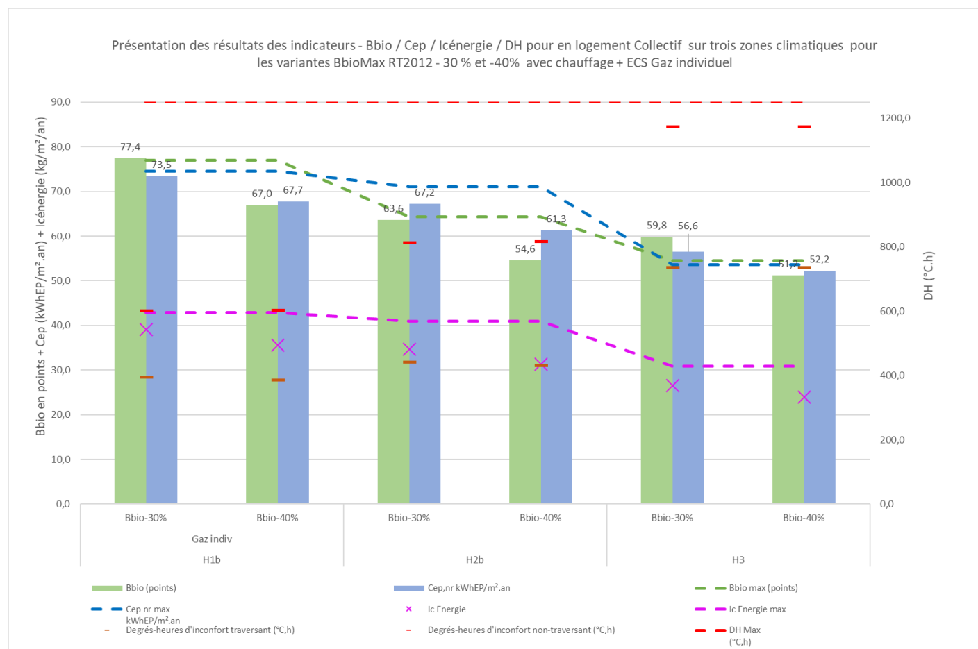
Figure 17 : Présentation des résultats des indicateurs Bbio, Cep, nr, Ic énergie et DH pour le logement collectif avec deux niveaux de performances « Bbio RT 2012 – 30 % » et « Bbio RT 2012 – 40 % » sur trois zones climatiques.
